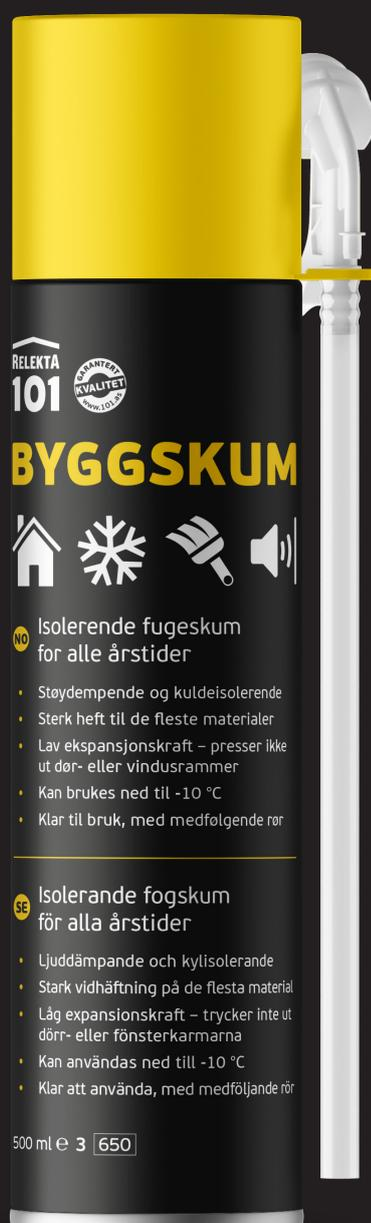
Helårs fugeskum til tetting, isolering og montering. Brukes med medfølgende rør uten behov for ekstra verktøy. Svært god heft til de aller fleste materialer med unntak av Teflon, PE- og PP plast, samt silikon. Gir ca. 20 liter ekspandert skum. 101 BYGGSKUM kan påføres i temperaturer ned til -10 °C, men boksen må være romtemperert.
